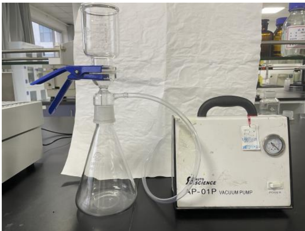
附件 2-2：抽滤装置（设备装置第 82 项）
