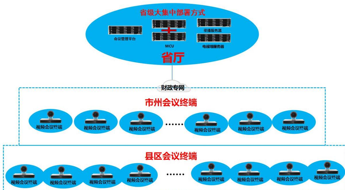
如上图所示，基于现有 IP 网络，采用 H.323、SIP 体系标准，购置 2 台 MCU、1 套会议管理平台、1 台录播服务器、1 台电视墙服务器、4 台视频会议终端，部署省级大集中的视频会议系统。确保全省各级财政部门各种视频会议迅速、准确地召开。
