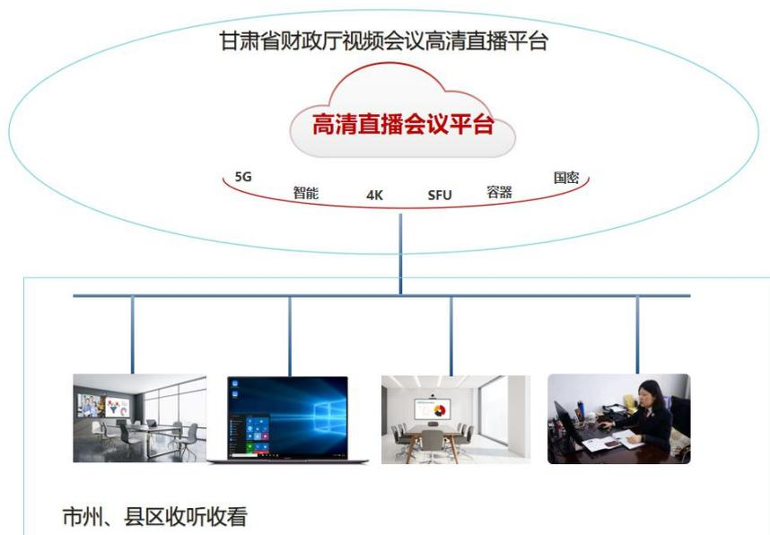
高清直播系统采用云+网+端方式部署，云端在省厅机房（信源、UHD 编码器、4K 流媒体服务器），由财政专网承载运行。各级财政部门通过相应终端观看省级直播视频（要求适配信创计算机+国产操作系统+客户端专用软件视听）。高清直播系统作为视频会议系统的备用支持，能够与现有视频会议系统同时运行，实现音视频内容的 WEB 浏览和点播功能，支持 PC、移动端等多类型设备观看，进一步提升会议系统的灵活性和实用性。
